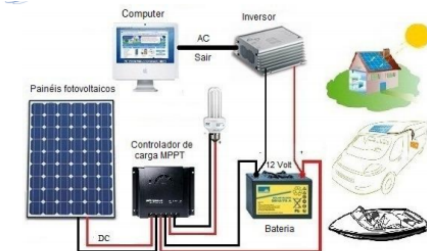
Figura 1. Diagrama elétrico fotovoltaico sistema on grid. (KEMERICH et al., 2016)
